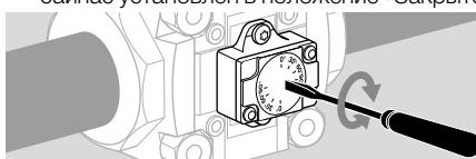
→ Мы рекомендуем записать установленное значение угла открытия на шильдике прибора.
