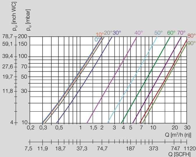
Кривые расхода измерены при закрытом клапане.
