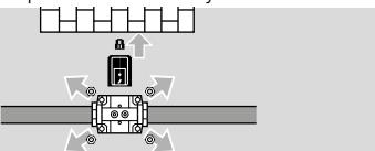
→ Давление на входе  $p_u$  и давление на выходе  $p_d$  могут измеряться с обеих сторон через измерительные штуцеры, см. Принадлежности.
