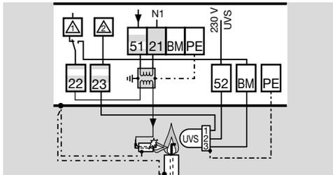
**Запальная горелка – одноэлектродная схема управления/основная горелка – UVC 1:**
