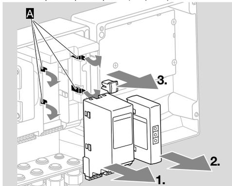
→ Установка модулей производится в обратной последовательности.
