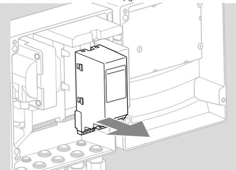
**4** Выкрутите предохранитель F1, F2 или F3 и проверьте его работоспособность.
