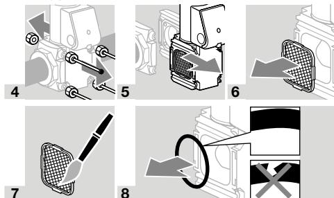
9 После замены уплотнений произведите сборку прибора в обратной последовательности.
