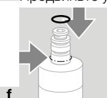
→ Если у прибора на месте, указанном стрелкой, имеется О-кольцо, замените привод описанным здесь способом: VAN 1: используйте все уплотнения из адаптерного комплекта для привода. VAN 2: используйте маленькое и только одно большое уплотнение из адаптерного комплекта для привода.
