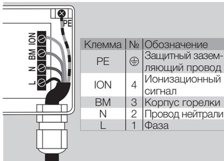
Схемы электроподключения автоматов управления горелкой
