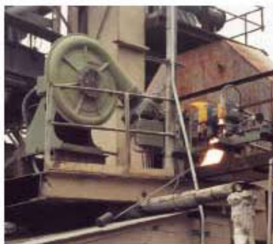
Горелка StarJet с коллектором подготовки мазута.
